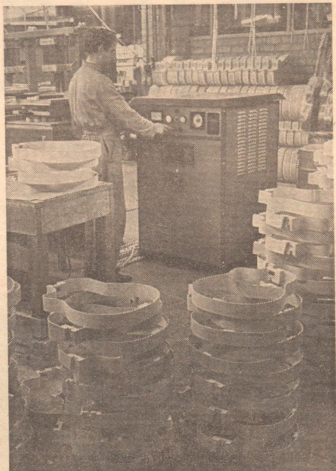
Met behulp van een hoogfrequent lijnapparaat van Philips worden hals, boven- en onderstuk, alsmede de zijranden gevormd tot het gitaarlichaam.
